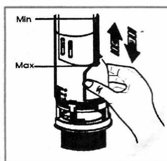
Nastavení hladiny částečného splachování.
