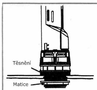
Odšroubujte matici, vložte výpustný ventil do otvoru v nádržce, ujistěte se, že je těsnění správně vložené a opět matici zašroubujte k ventilu.
