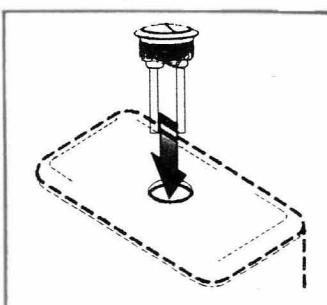
Upravte délku nástavného ramena na požadovanou délku a vložte splachovací tlačítko do otvoru v nádržce.
