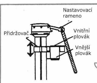
Otočte nastavovací rameno o 90 stupňů a uvolněte, vytáhněte nebo stlačte držák a upravte výšku vodní hladiny. Stlačte vnitřní plovák, nastavte rameno do nejspodnější polohy a natočte nastavovací rameno o 90 stupňů.
