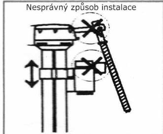
Jakmile je nástavné rameno nastavené v nejnižší poloze nastavte vnitřní a vnější plovák do stejné výšky a vložte nástavné rameno do vnitřního plováku.
